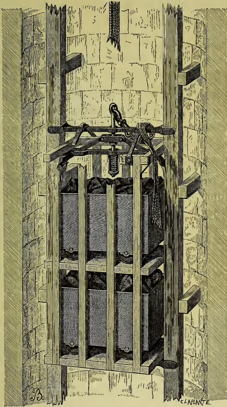
Fig. 89. — Cage d'extraction à parachute (système Fontaine). Ech. 1/50.
